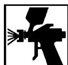
Appliquer au pistolet équipé d'une buse ø1,2-ø1,3 mm à une pression d'air de 2,0 à 2,5 bars.
